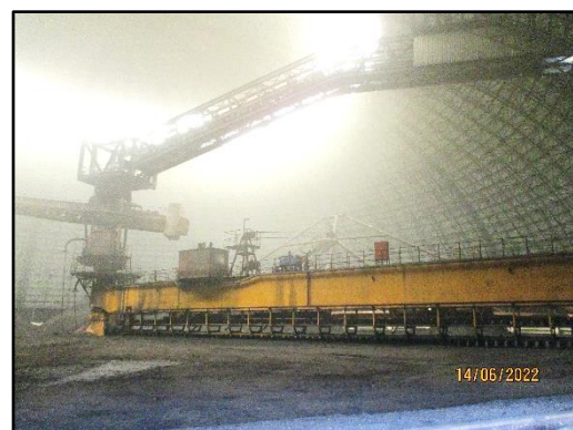
ภาพที่ 2.52 โดมเก็บถ่านหิน และตัวกวาดถ่านหิน (Reclaimer)
