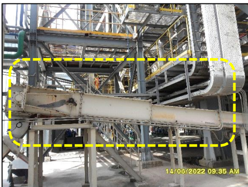
ภาพที่ 2.11 ระบบสายพานลำเลียงไถ่จากหน่วยการผลิตเข้าสู่ไซโลเก็บเป็นระบบปิด
